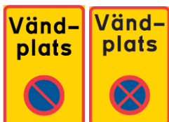
Figur 18. Reglering av vändplats med parkeringsförbud alternativt parkerings- och stannandeförbud.
